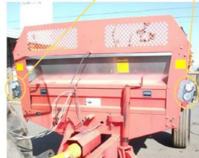
後部反射器及び灯火器類の設置例
