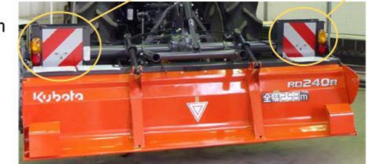
農作業機への反射器(後面:赤)、灯火器(前面:白、後面:赤)及び外側表示板(前後両面)設置例
