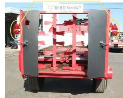
後部反射器及び灯火器類の設置例
